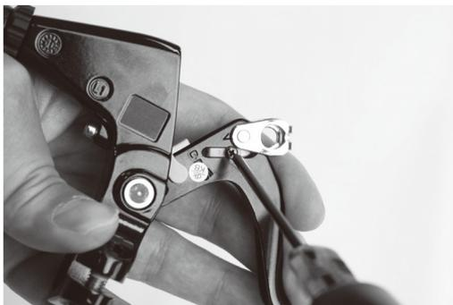
2. Impostare il selettore di modalità sulla posizione della modalità per il freno installato.
