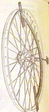
51012 — Apparecchio per controllo ruote centrate
