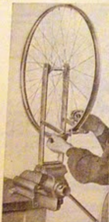
50013 — Centraruote universale adatto per tutte le misure di cerchi, con congegno mobile per la centratura
