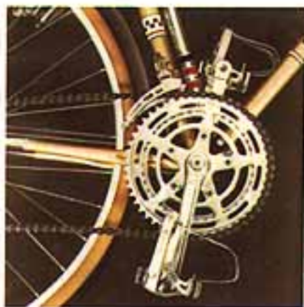
Kettingwiel Stronglight Competition no. 99. U ziet hierop ook de pedalen Lyotard 45 CA en de Simplex Super LJ voordérailleur.
