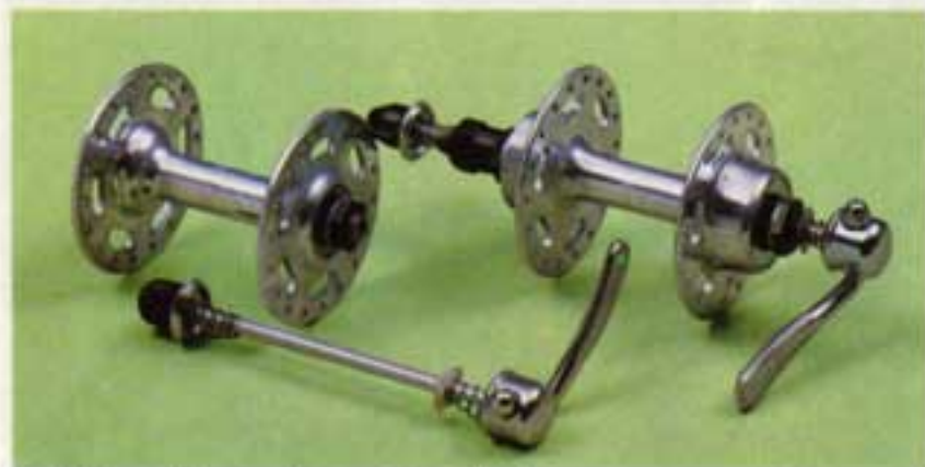
Lichtgewicht uitvalassen van Maillard.
