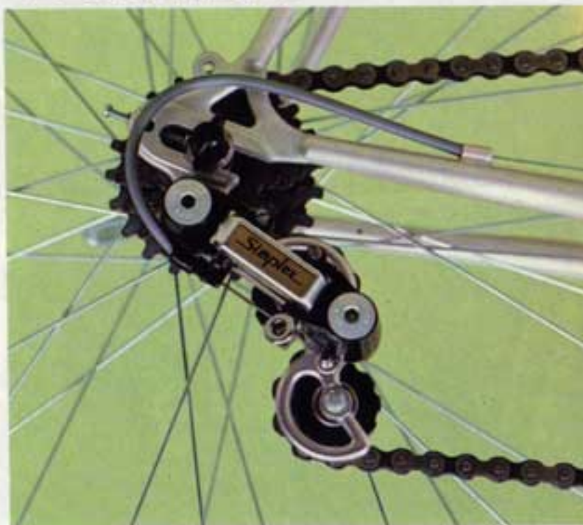
Duidelijk zichtbaar zijn de Delrin componenten, waaruit de deraillieur is opgebouwd.
