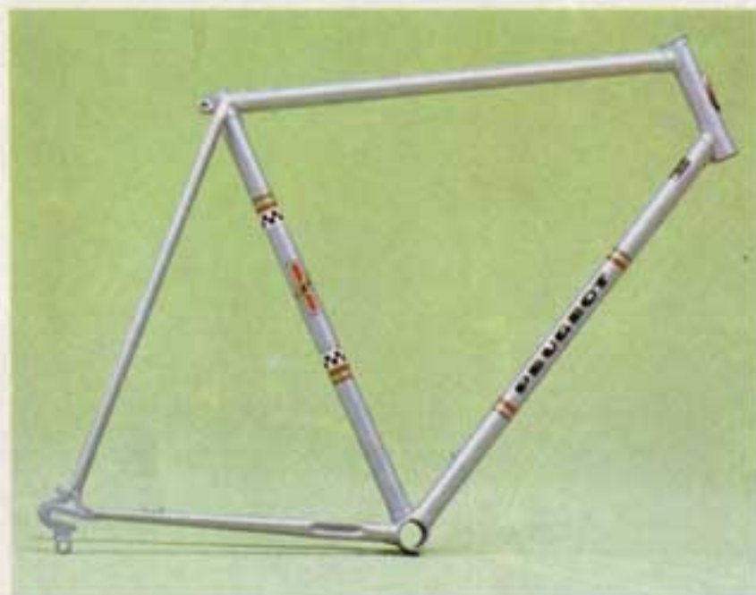
Frame van de PS10, opgebouwd uit Reynolds buizen.
