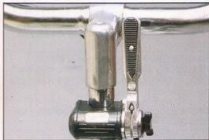
Robuuste 5-versnellingsderailleur met handige klikscakelaar.
