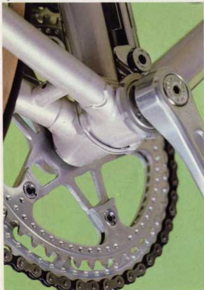
Détail opgesoldeerde kabelgeleider.
