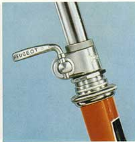
Met deze beugel kunt u gemakkelijk uw stuur verstellen. Een dergelijke constructie geldt ook voor het zadel.
