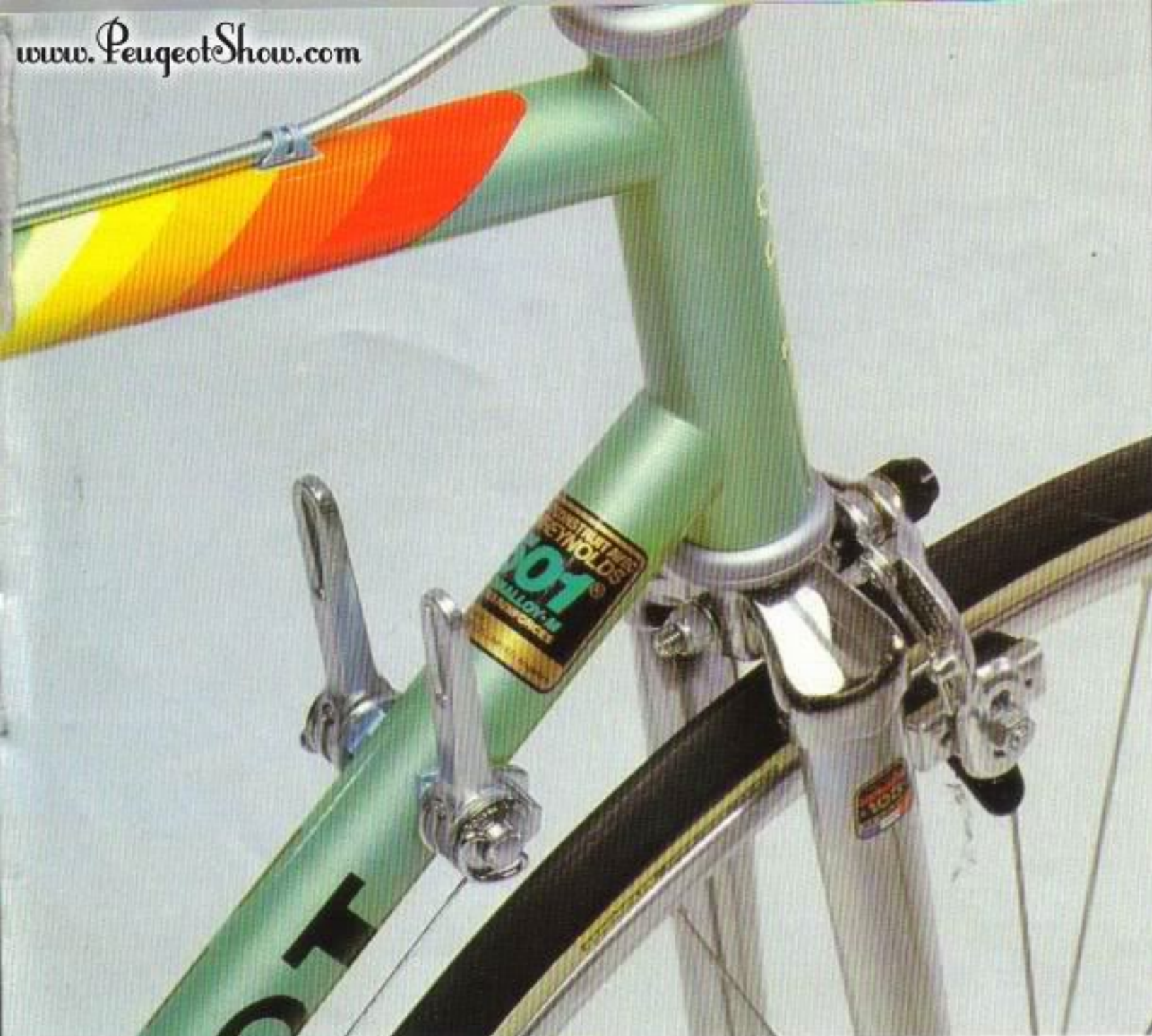
Muffenloser Steuerkopf mit REYNOLDS 501-Rohren
