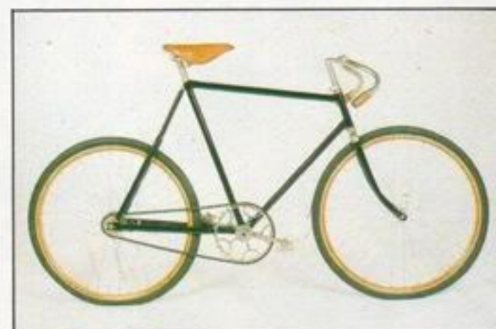
- Peugeot Oldtimer racefiets "Tour de France" uit 1908. Met houten velgen, 24, 26 of 27 tands kettingblad maar zonder derailleur!
