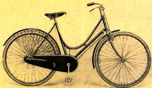
PERLA Mod. 55. - Da signora. - Manubrio a due freni leve esterne, manopole celluloidi, parafanghi, paracaleno chiuso, paraveste seta, ruota libera. Ruote 26 \times 1 \frac{3}{8} .
